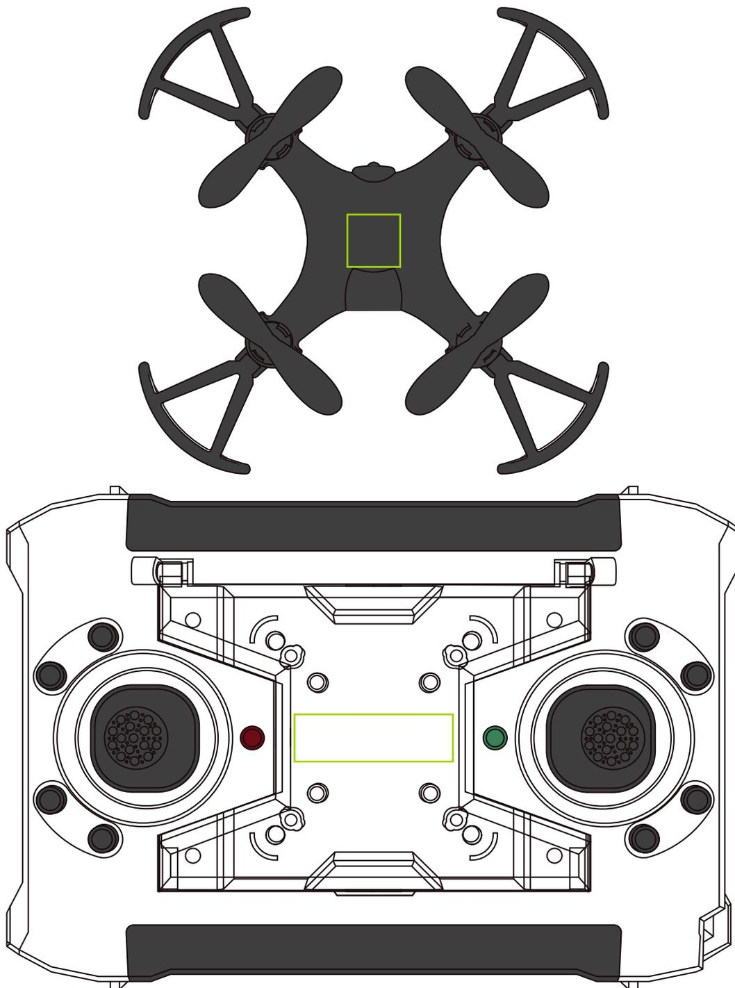
Drohne / drone: 53 x 53 x 29 mm; Fernbedienung / remote: 139 x 96 x 45 mm; Maßstab / scale: 1:1
